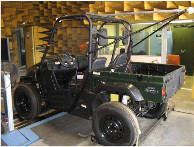
Fig. 4. FIAIWM EGV chassis dynamometer test setup.
